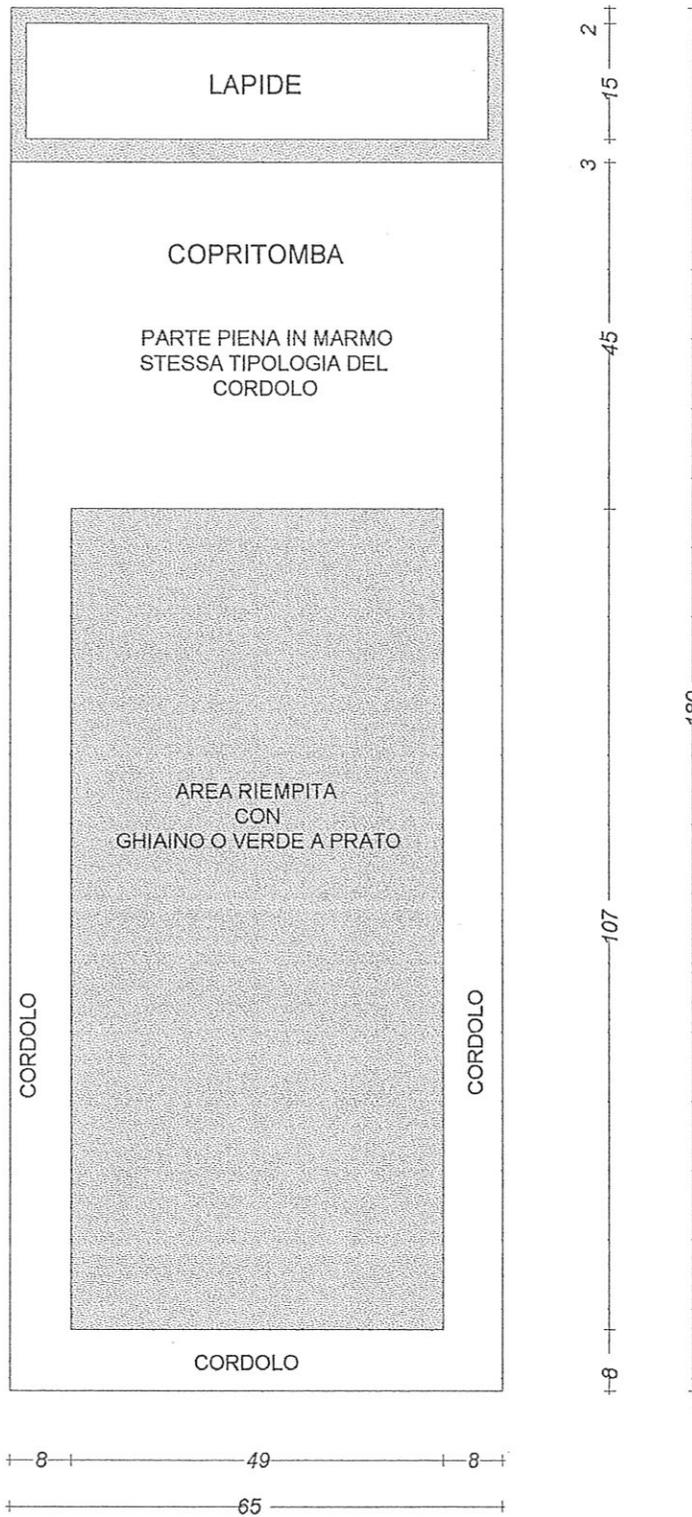
SCHEMA LAPIDE PER INUMAZIONE - PIANTA - MISURE IN CM.
