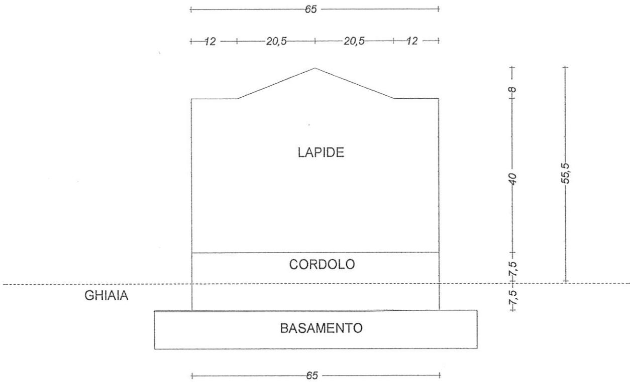
SCHEMA LAPIDE PER INUMAZIONE - PROSPETTO - MISURE IN CM.
