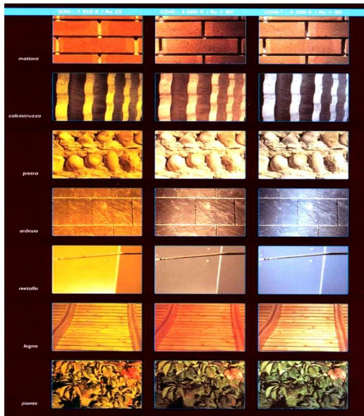
Figura 13. Il colore dei materiali viene influenzato dalla composizione dello spettro della lampada. Esempi di come appaiono le varie superfici con sorgenti rispettivamente calde (sodio alta pressione 1950K), intermedie (ioduri metallici bruciatore ceramico 3000K) e medio fredde (4200K).
