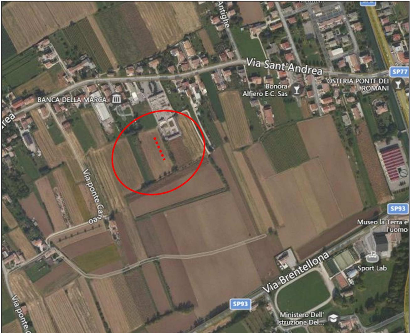
Lo stendimento sismico geofonico lineare multicanale con geofoni verticali (4.5 Hz) è stato posizionato e utilizzato per le prospezioni sismiche tipo MASW (Multichannel Analysis of Surface Waves), ReMI (Refraction Microtremor) e Sismica a Rifrazione, analizzano le onde di superficie.
