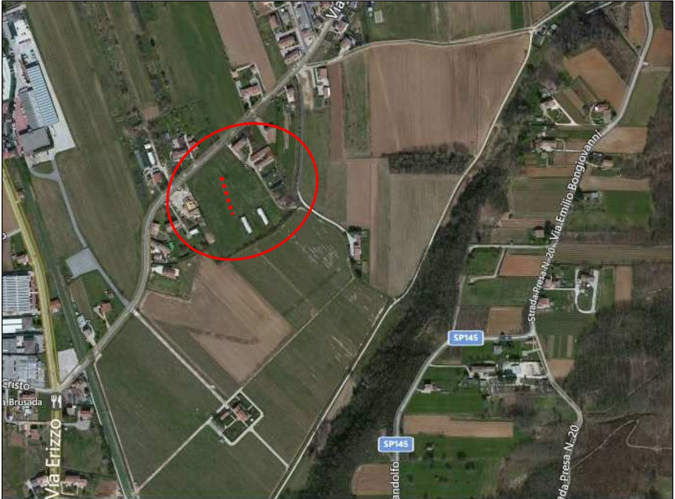
Lo stendimento sismico geofonico lineare multicanale con geofoni verticali (4.5 Hz) è stato posizionato e utilizzato per le prospezioni sismiche tipo MASW (Multichannel Analysis of Surface Waves), ReMI (Refraction Microtremor) e Sismica a Rifrazione, analizzano le onde di superficie.
